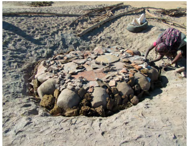
الشكل ١٩ ► أفران الفخار في قرية جبارينة على شكل حفرة بها قطع معدنية وألواح في الأعلى؛ لعزل وحماية الأواني من اللهب، ومراحل مختلفة من التحضير للشّي. تصوير: ب. فرانسيك.
